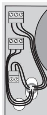
Da im Gehäuse nicht viel Platz zur Verfügung steht, verwenden Sie für den Anschluss ein Telefonkabel mit nicht mehr Adern als notwendig. Der Kabelmantel sollte nur bis kurz hinter der Einführung in das Gehäuse reichen. Beachten Sie für eine günstige Verlegung innerhalb des Gehäuses die nebenstehende Abbildung.
