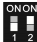
L'interrupteur 2 permet de revenir à la configuration IP par défaut : basculez l'interrupteur 2 sur ON puis redémarrez le portier. Vous pouvez alors accéder au portier par l'adresse IP 192.168.1.250. Une fois redémarré, rebasculez l'interrupteur en position OFF (normal).
