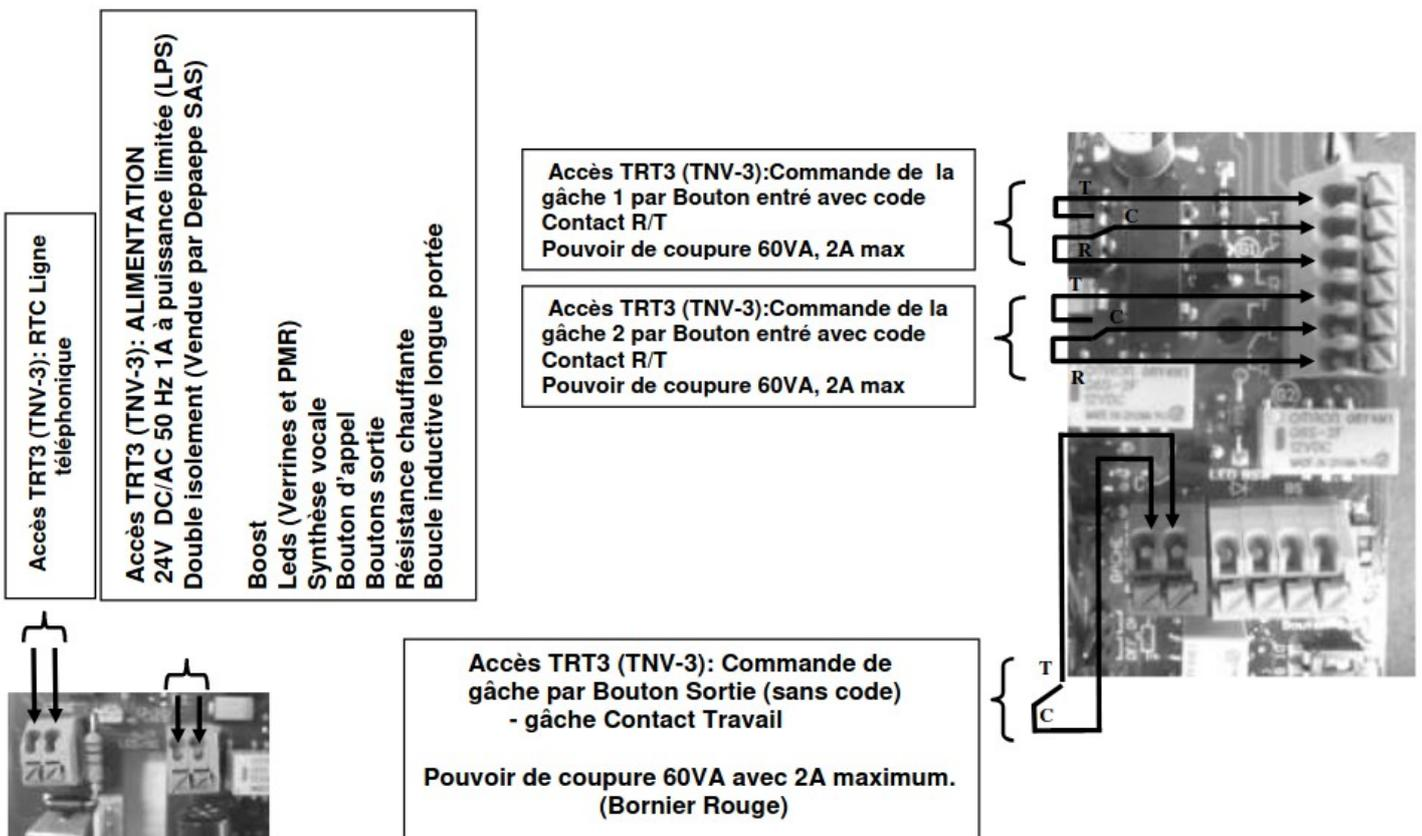
Ce terminal est conçu pour être raccordé sur un accès classé TRT3 (TNV3) au sens de la norme EN 60950-1 : 2006
