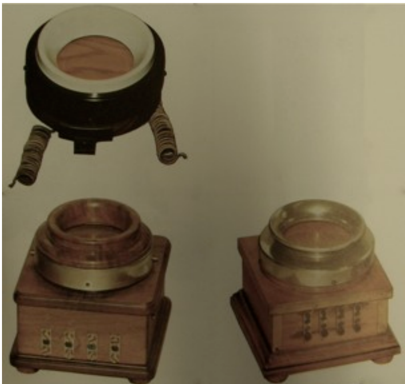
Mikrophon mit Porzellantrichter und Holzmembrane um 1890
